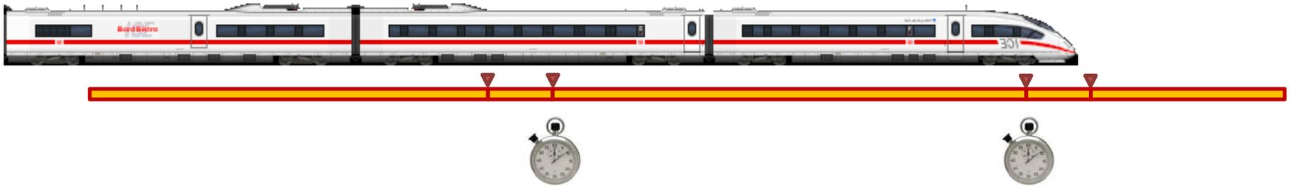
Nach Durchfahren der Messstrecke wird die ermittelte Geschwindigkeit angezeigt.
